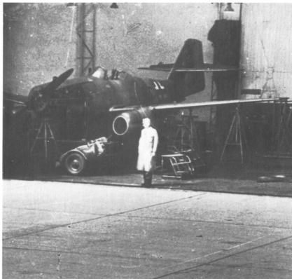
Das war die erste Me 262, die am 25. 3. 1942 mit einem Jumo 210 G und zwei BMW-Triebwerken startete und mit ausgefallenen Turbinen kaum über eine Platzrunde kam.
