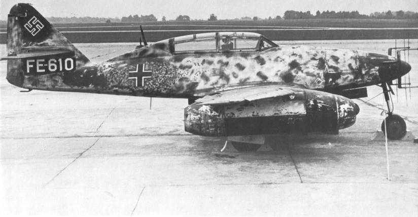
Dieser zweisitzige Übungsjäger (B-1a), der mit einem Liechtenstein-Gerät SN 2 ausgerüstet wurde und versuchsweise zur Nachtjagd über dem damaligen Reichsgebiet eingesetzt werden sollte, kam nicht mehr zum Einsatz. Es könnte sich hier um die Nachtjagdversion handeln, die sich Kurt Welter in den letzten Kriegswochen hat bauen lassen. Sie fiel unversehrt in amerikanische Hände.
